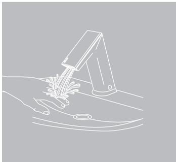
Al aproximar las manos del usuario al rango del campo magnético, el sensor activa la válvula solenoide permitiendo la salida de agua por la grifería. El agua fluye hasta que las manos se retiren o hasta que la grifería alcance su configuración de límite automático de pausa.
