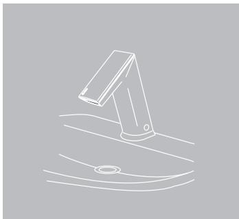
Al retirarse las manos de la llave, el sensor capacitivo desactiva la válvula solenoide, cortando el flujo de agua. El sistema se restablece automáticamente y está listo para el siguiente usuario.
